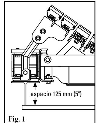
Si se desconoce la clasificación CEMA, mida la altura del primer y último rodillo desde la parte superior del rodillo del centro a la parte superior de la estructura del transportador. La Tabla 2 muestra la altura central nominal requerida para el rodillo con base en el ancho de banda. Si es incorrecta, coloque alzas a los rodillos para llegar a la altura que se muestra en la Tabla 2.
