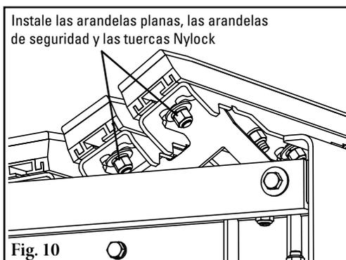
10. **Ajuste las barras de impacto.** Con todas las barras de impacto colocadas correctamente en los soportes de extensión, instale una arandela plana, arandela de bloque y tuerca nylock en cada soporte. Apriete las tuercas a una torsión de 135 N-m (100 pies-lb) (Fig. 10). Quite las mordazas en C de los amortiguadores.
