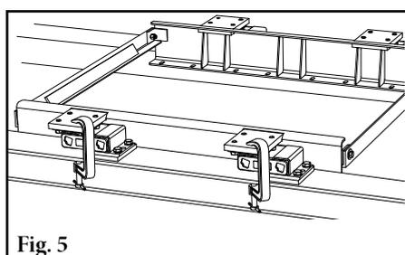
5. **Coloque los rieles de suspensión.** Comprima los rieles de suspensión con cuatro mordazas C para proporcionar un espacio libre adicional de 63mm (2.5") para el ensamblaje (Fig. 5).
